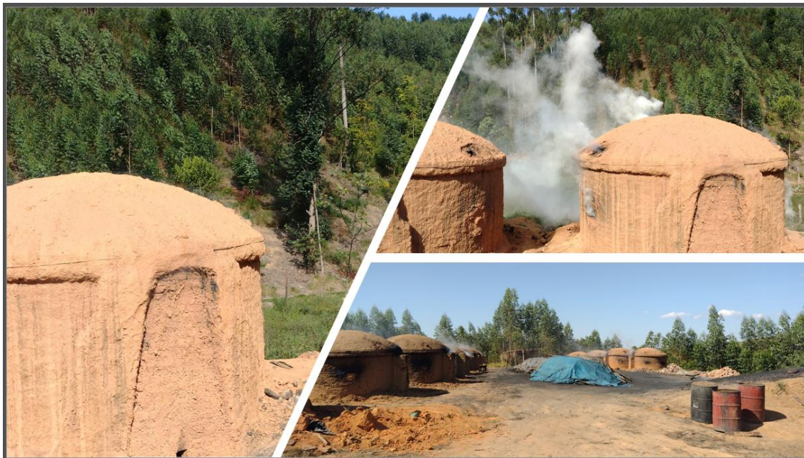
Figura 4: Fornos utilizados para carbonização do eucalipto e produção de carvão vegetal na Comunidade
