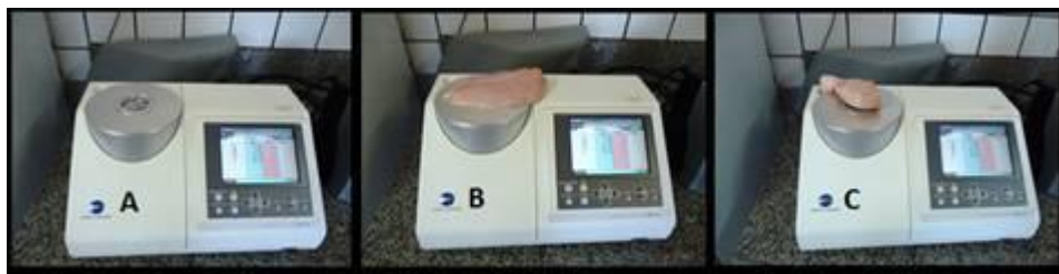
Figura 2: A) Colorímetro de bancada CM-5 Konica Minolta. B) Leitura da cor do corte peito. C) Leitura da cor do corte coxa.
